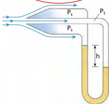
tubo di Pitot è fornito di due prese di pressione, una all'estremità anteriore, disposta perpendicolarmente alla corrente (presa totale, ovvero la pressione  $P_t$  misurata dopo aver fermato il flusso), e una sul corpo del tubo, disposta tangenzialmente al flusso (presa statica che misura la pressione  $P_s$ ).
