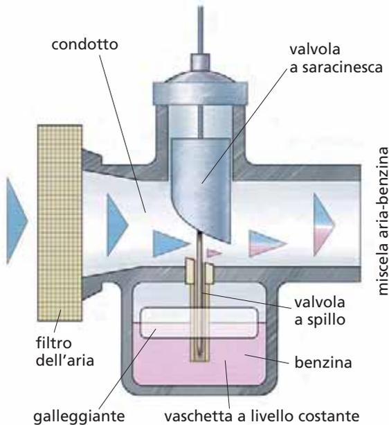
fatto passare per una strozzatura del condotto di aspirazione. In questa strozzatura si trova un piccolo forellino, in comunicazione con una vaschetta piena di benzina. A causa della strozzatura la velocità del fluido aumenta e la pressione diminuisce: in questo modo la benzina viene aspirata da una vaschetta collocata 5 cm sotto la strozzatura e miscelata al flusso d'aria.
